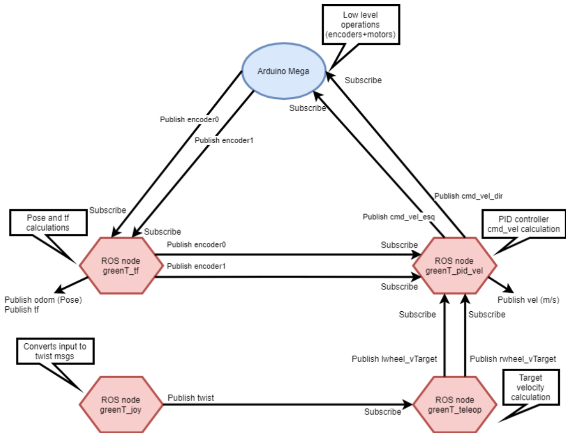
Figura 19: Arquitetura de Nós ROS do GreenT com controlo por Joystick
