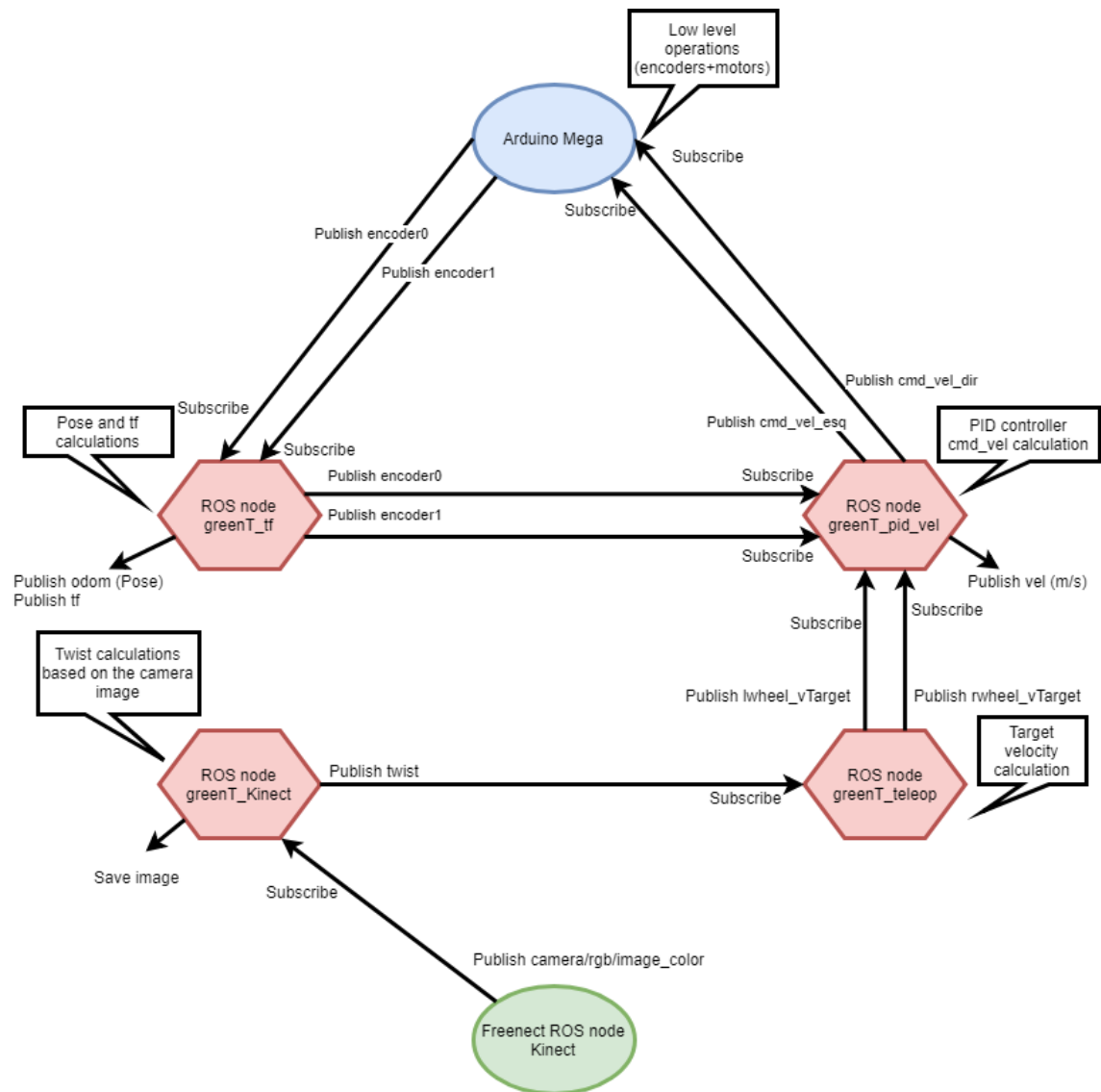
Figura 23: Arquitetura de nós ROS utilizando a Kinect
