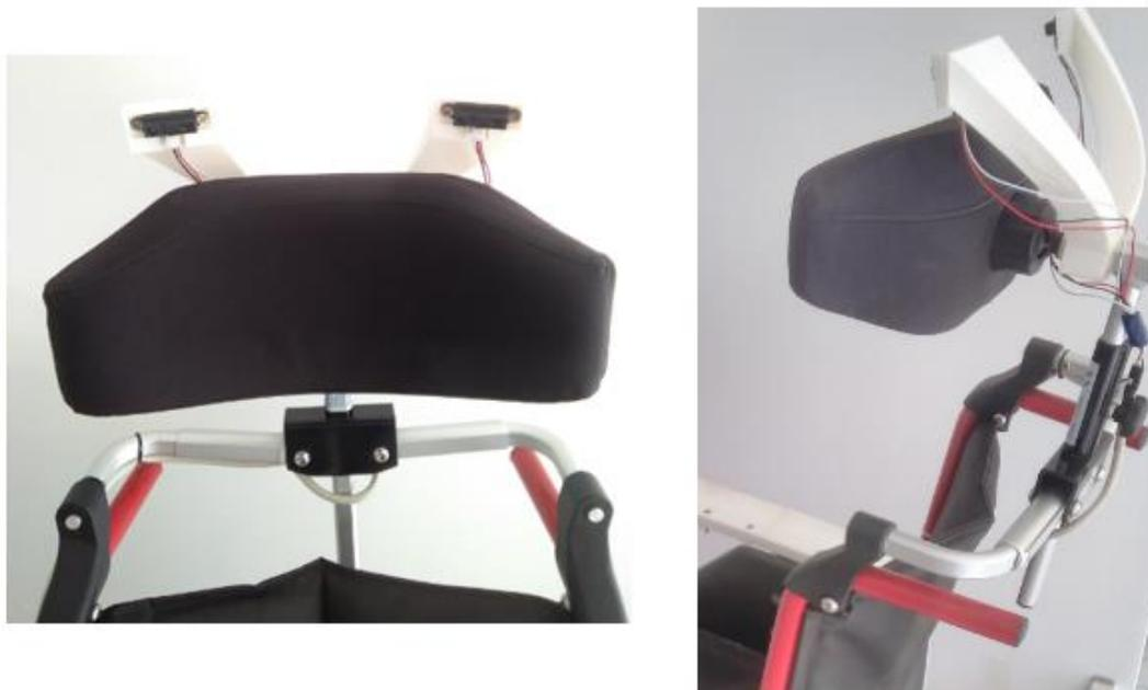
Figura 93: Implementação do suporte dos sensores de distância do sistema que deteta a presença da cabeça
