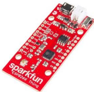
Figura 19: Placa de desenvolvimento com módulo Wi-Fi - ESP8266-Thing
