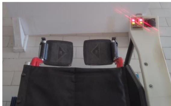
Figura 95: Localização do botão de emergência e indicação por LEDs quando pressionado
