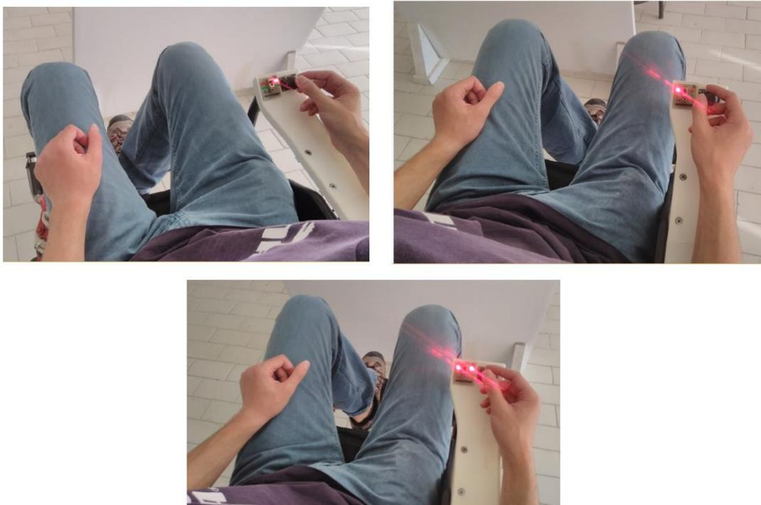
Figura 96: Exemplo do sistema de deteção de obstáculos (com indicação por LED) a funcionar para os casos em que à frente da cadeira se encontra um obstáculo: chegado à direita, chegado à esquerda e em todo o plano
