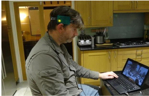
Figura 10: Controlador de um rato por movimentos de cabeça
