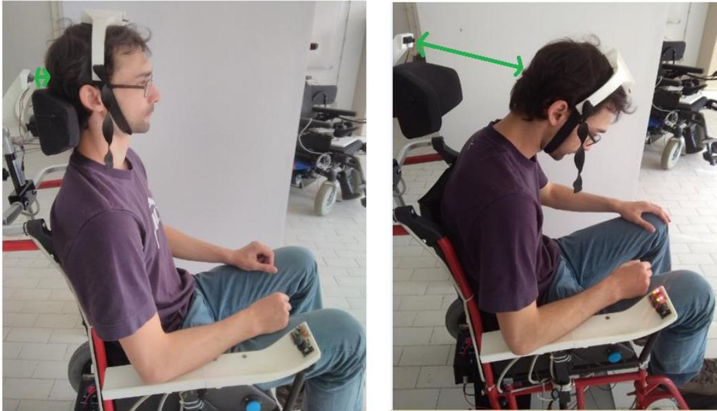
Figura 97: Exemplo do sistema de deteção da presença da cabeça do utilizador na área de segurança com a indicação por LEDs (todos a piscar) quando a presença da cabeça não é garantida
