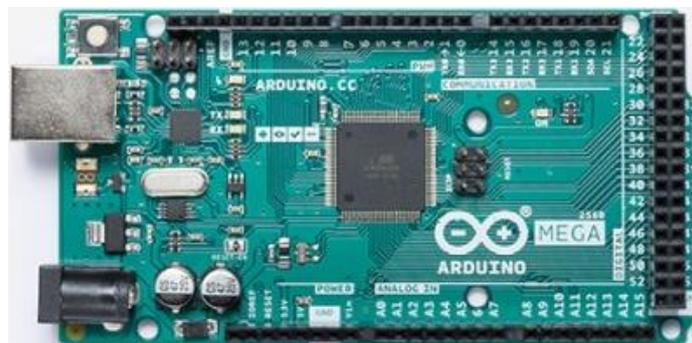
Figura 20: Microcontrolador Arduino Mega2560 [18].
