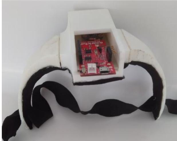
Figura 94: Resultado final do capacete em forma de bandeleite no qual está inserido o Headset
