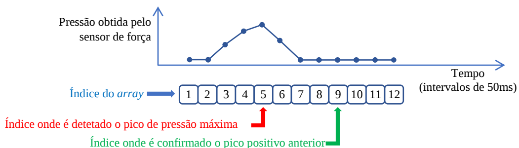
Figura 22 - Método para deteção de picos nos valores dos sensores de força
