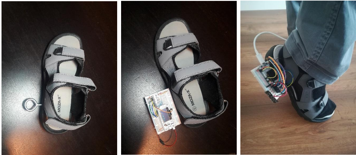
Figura 30 - Montagem dos sapatos provisórios
