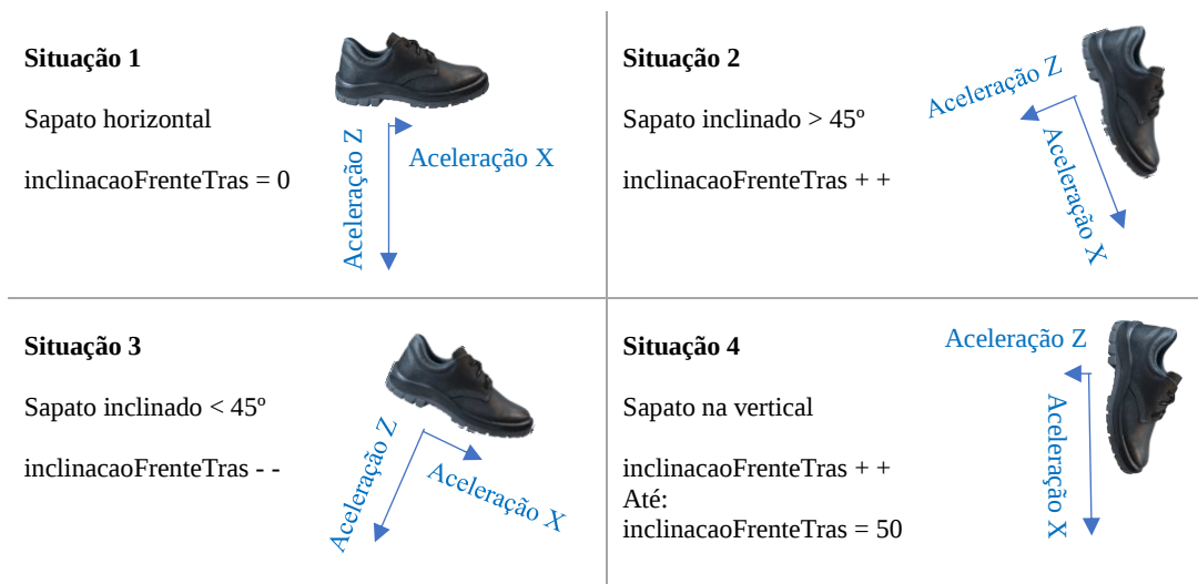
Figura 25 - Situações possíveis na deteção de inclinação dos sapatos
