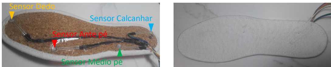
Figura 31 - Localização dos sensores na palmilha (esquerda) e palmilha vista de cima (direita)
